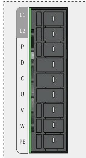
图 4.3 主电路端子引脚分布示
