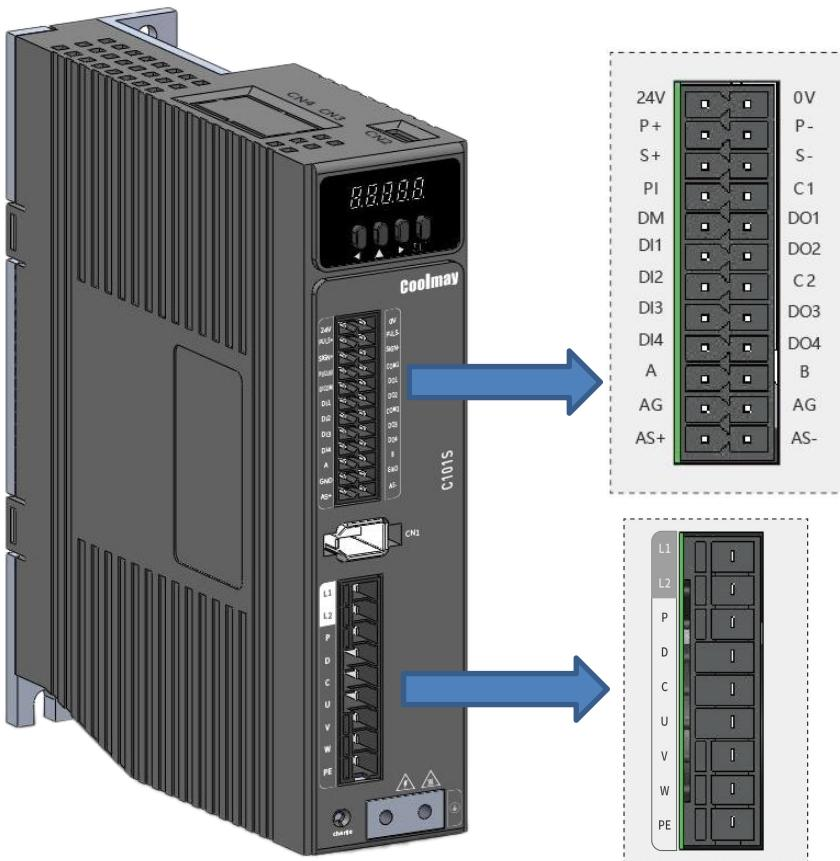
图 4.2 C600S 端子引脚分布示意图
