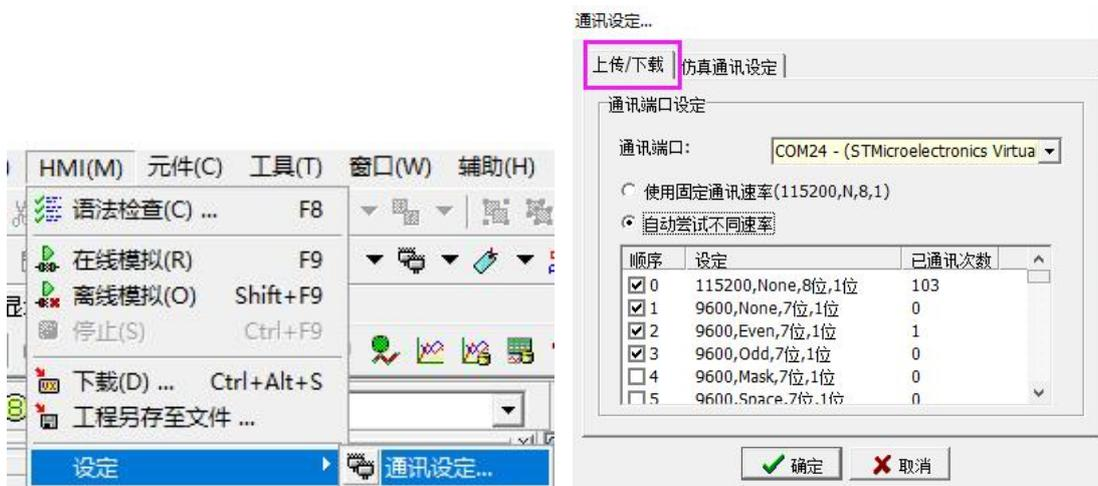
在通讯设定窗口的【上传/下载】中对 PC 端的通讯口做指定，即下载线连接在 PC 上的端口。如 COM24，可配合人机的【下载画面】选择【使用固定通讯速率】，或让 PC 自动尝试不同速率下载。接着选择【HMI】→【下载】，之后便开始将 HMI 程序下载至人机，如下图所示：
