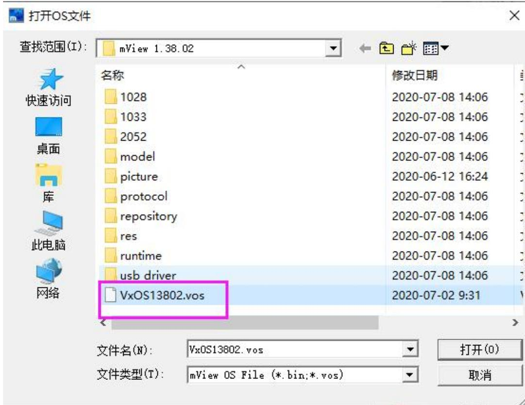
步骤三：开始下载。（注：下载 OS 的过程中，HMI 不可断电！）
