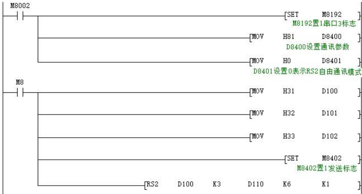
使用串口工具监控串口 3 得到的数据为：[2017:11:01:11:49:16][接收]31 32 33
