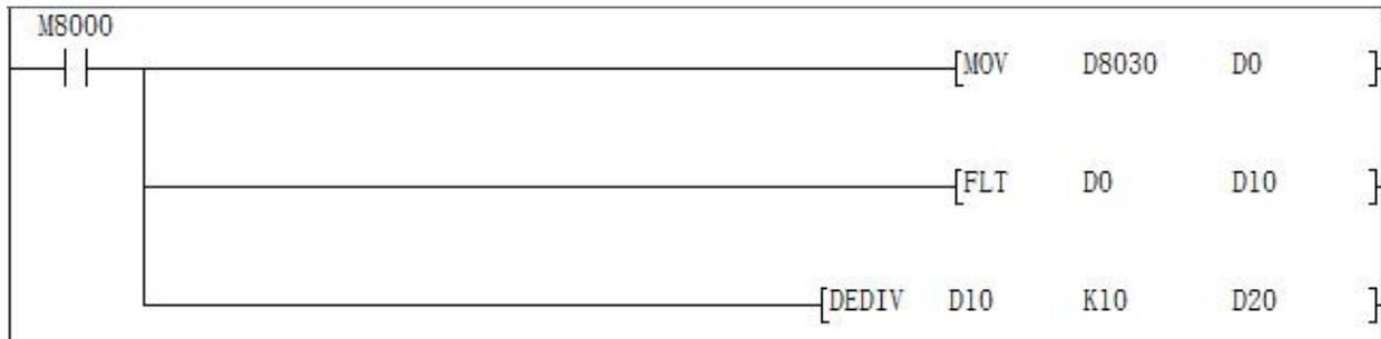
将温度传感器的信号端接入 PLC 的 ADO 输入端，另一端接入模拟量输入端口的 GND。当 PLC 运行时，ADO 对应的数据寄存器 D8030 的值将传给 D0，将 D0 的值进行浮点数运算后放入 D10，再对 D10 进行浮点数除法运算运算，运算结果放入 D20，结果 D20 就是实际温度值。在梯形图中，也可以直接对 D8030 的值进行除法运算。
